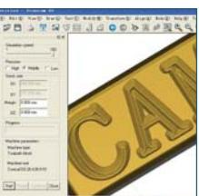
**SOFTWARE:** Programa de CAD CAM UCANCAM con postprocesador especialmente diseñado para la conversión de los trabajos al lenguaje máquina. Con este software puede directamente, procesar imágenes, grabar textos, grabar series de números, repetir trazados a lo largo de un camino y repetir un trabajo en forma matricial. Posee autonesting para la óptima utilización del material.
